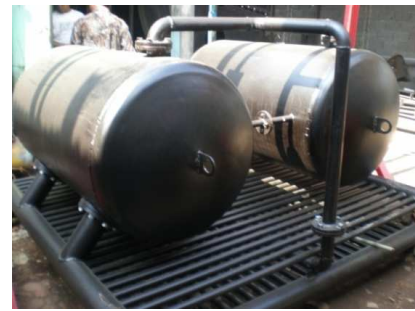
Gambar 7. Ketel uap berbahan bakar limbah hasil rancang bangun
