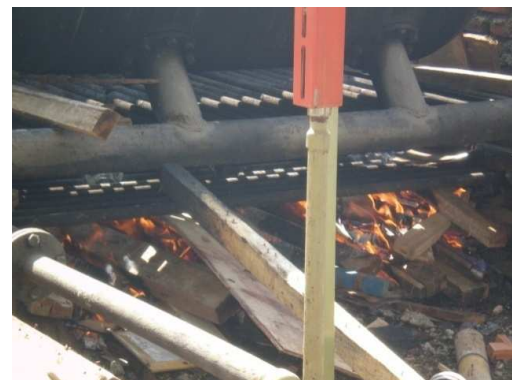
Gambar 10. Menggunakan bahan bakar kayu-kayu bekas (limbah pembangunan).
